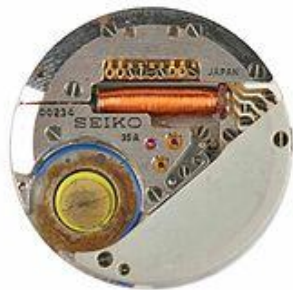
Quartz Movement of the Seiko Astron, 1969 (Deutsches Uhrenmuseum, Inv. 2010-006)
